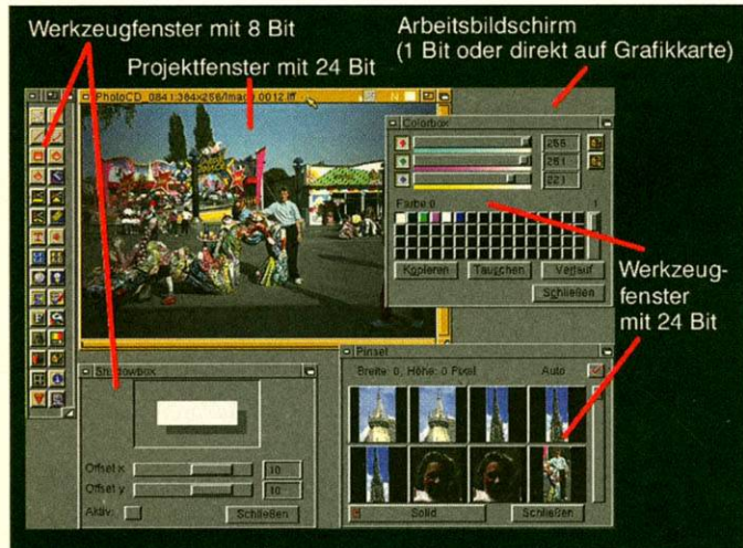
Prinzipsache: XiPaint geht sparsam mit dem Speicher um. Nur wenn es notwendig ist, werden 24 Bit verwendet, sonst kommen 8-Bit-Fenster zum Einsatz.
