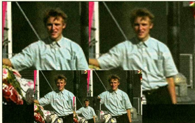
Kantenlos: Wird beim Vergrößern von Pinseln das Antialiasing aktiviert, erhält man wesentlich bessere Ergebnisse
